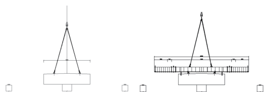
(a)单机抬吊预制盖梁 (b)中节段盖梁安装钢扁担 图5 中节段盖梁与钢扁担安装示意图
