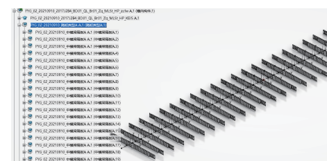
图 8 由工作指令在骨架上自动化生成的中横梁隔板 A
