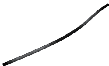
图 3 围压作用下钢管屈曲模态
