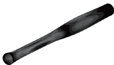
图 2 轴压作用下钢管屈曲模态
