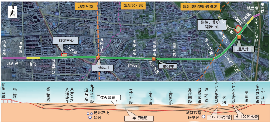
图 9 北京广渠路东延项目平纵面图
