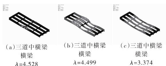
图 14 跨间横梁刚度对稳定的影响图示
