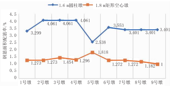
(a)墩柱配筋率对比图
