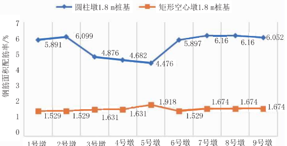
(b)桩基配筋率对比图
