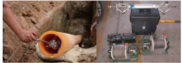
图 8 陀螺仪法应用实例
