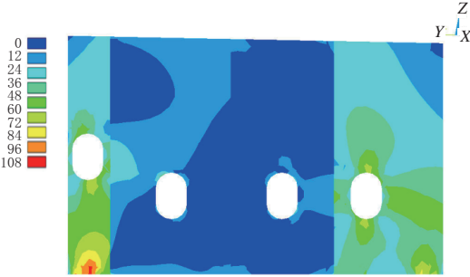
图 14 横隔板的 Mises 应力分布图(单位:MPa)
