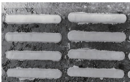
图 2 脱模后边角存在瑕疵
