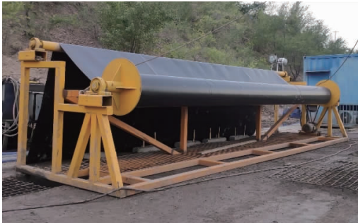
图 3 自制铺膜机实物图
