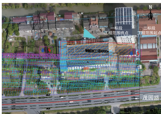
图9 基于正射影像的施工总平面图布置
