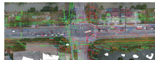
图11 错综复杂的综合管线分布图
