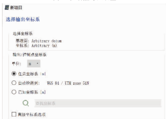
图7 控制点刺点导入坐标系统设置
