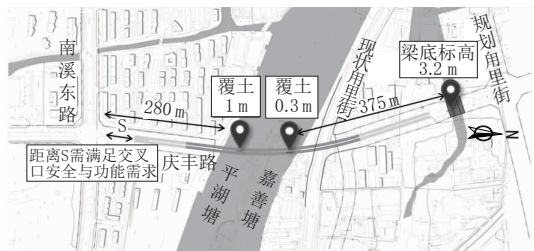
图7 隧道总体布置主要控制因素示意图
