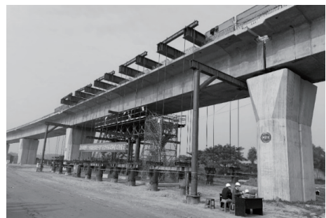
图 4 箱梁静载试验加载和反力系统
