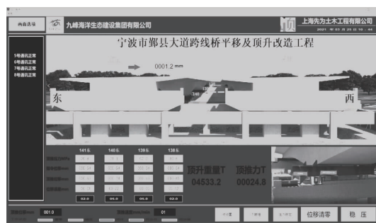
图7 平移施工 PLC 同步控制系统截图
