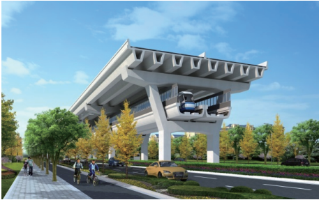
图 2 公铁一体化双层高架桥透视图
