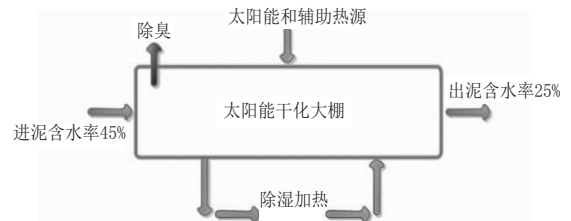
图3 太阳能干化工艺流程图
