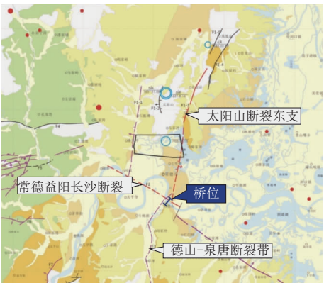
图 3 桥位处地震断裂带分布图
