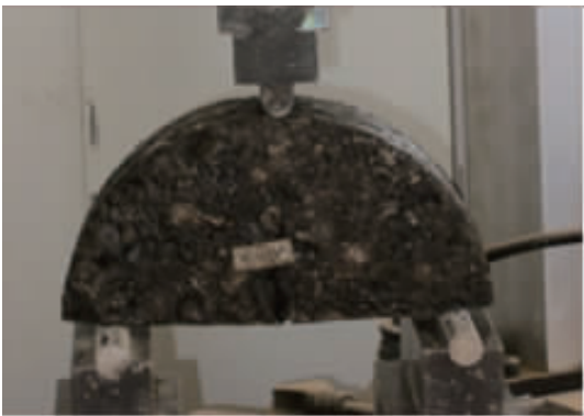
图 1 半圆弯曲试验试件
