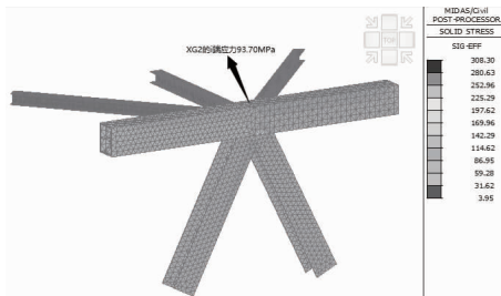
图11 多尺度模型节点实体单元 von Mises 应力图(单位:MPa)
