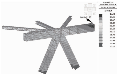
图10 多尺度模型节点实体单元位移图(单位:mm)
