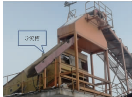
图 5 导流槽改装装置
