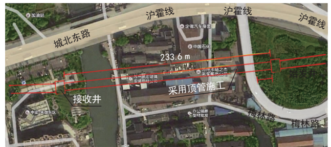
图1 矩形顶管平面布置示意图(单位:m)
