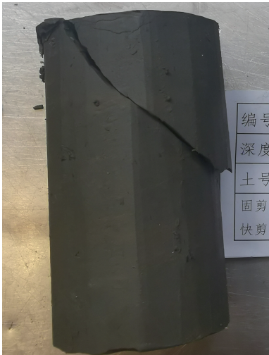
图9 无侧限抗压强度破坏图
