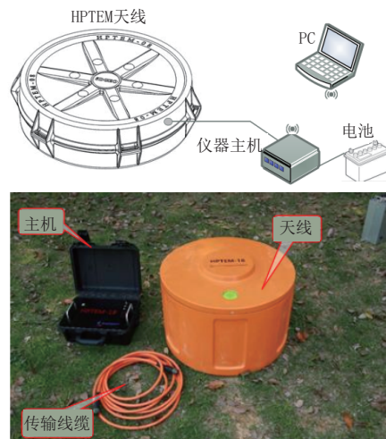
图 8 HPTEM-18 型高精度瞬变电磁系统
