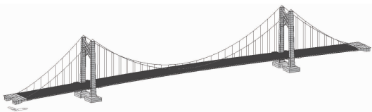
图 5 全桥有限元模型
