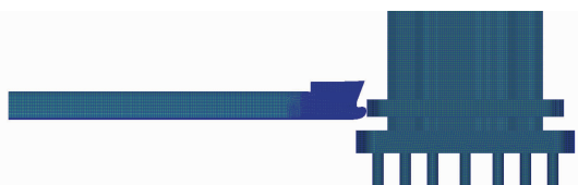
图 6 船与钢套箱碰撞有限元模型
