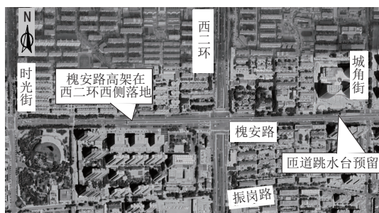
图3 槐安路与西二环节点道路现状
