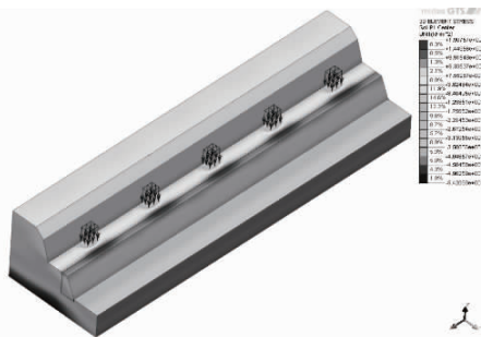
图 6 X=8 m 时边坡土体第一主应力云图
