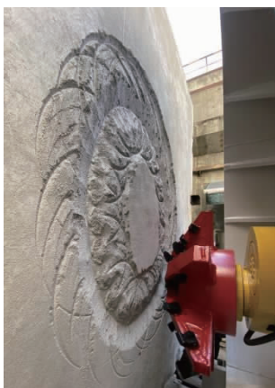
图 6 推进模式优化后的切削效果
