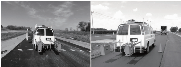
图 2 基于 GPR 干燥沥青密度静态检测 [8]
