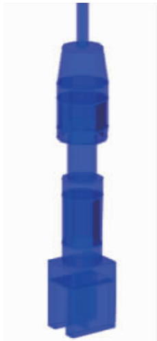
图4 吊杆下锚固端几何模型
