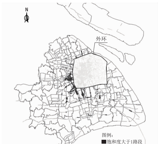
图3 普通干线公路交通运行现状
