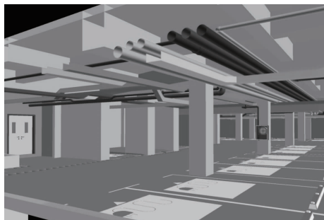
图3 某地下停车场 BIM 模型
