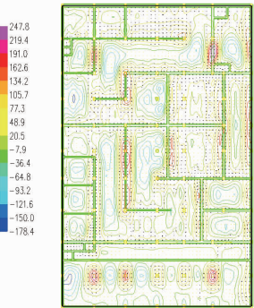
图 19 YJK 底板弯矩云图(单位: kN·m/m)
