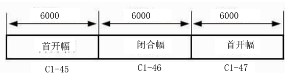
图12 试验段分幅图(单位:mm)
