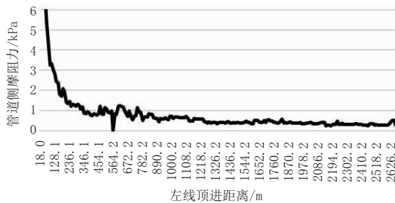
图 2 左线侧摩阻力随顶进距离变化曲线
