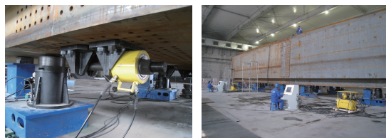
图9 钢塔节段两两水平预拼装
