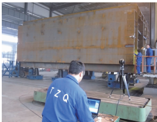
图7 钢塔节段端面加工后测量
