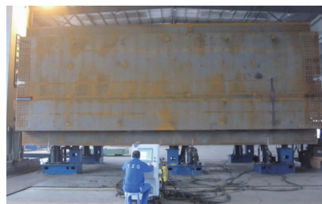
图4 塔段支撑反力调整
