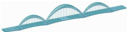
图 5 整体计算模型
