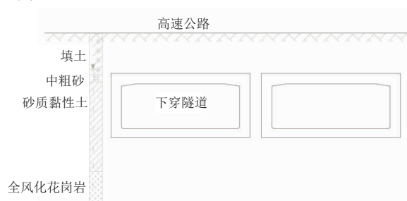
图4 地层和隧道分布图
