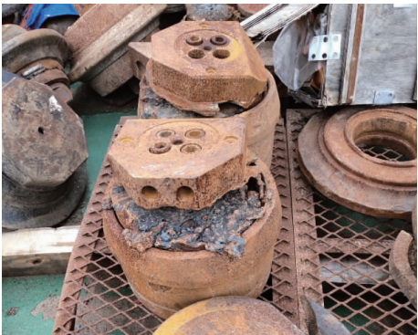
图 5 轴承损坏现场图
