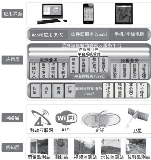
图 3 快速路桥梁结构健康监测系统架构图
