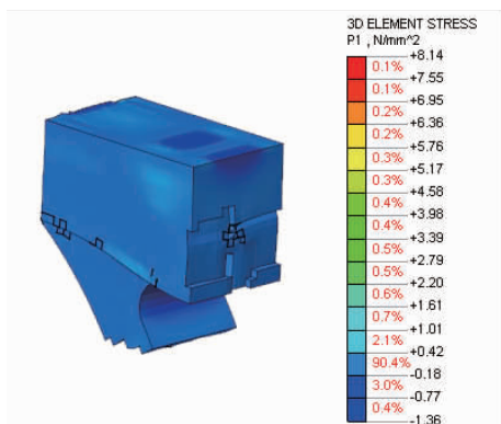
图3 墩柱与横梁交接处主拉应力图(单位:MPa)
