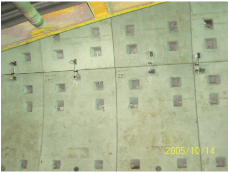
图6 邻接块与标准块接缝测点的现场状态图示
