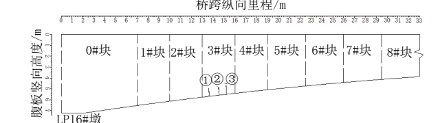
图 4 典型桥跨箱梁腹板裂缝分布图
