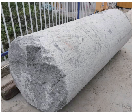
图 13 旋挖钻取出芯样
