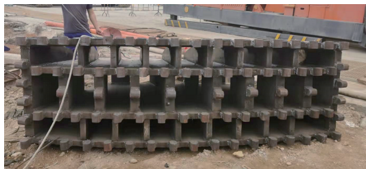
图 6 方锤损坏变形
