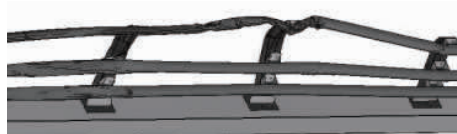
(a)大型车碰撞后SB级护栏变形图
