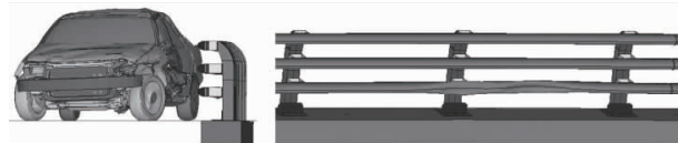
图3 A级结构小客车仿真碰撞
