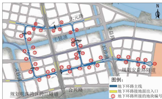
图 5 地下环路内部出入口布局
