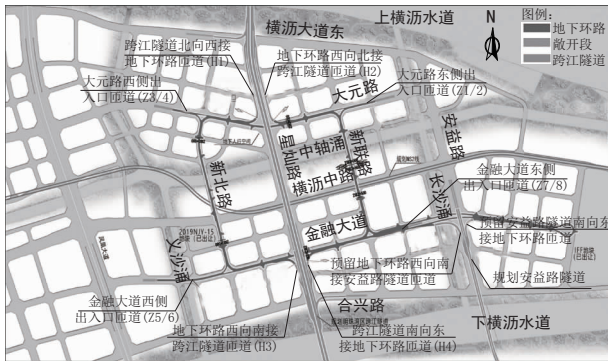
图1 南沙横沥岛尖地下车行环路示意图
