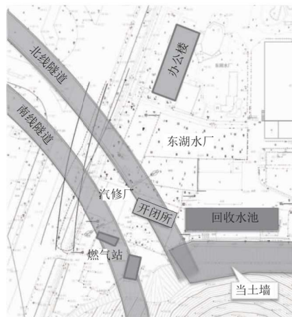
图 2 隧道下穿开闭所平面位置关系图
