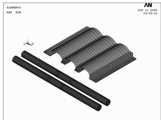
图4 桥梁隧道位置关系图
