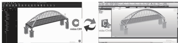
图 12 Midas CIM 与 Midas civil 相互导入图
