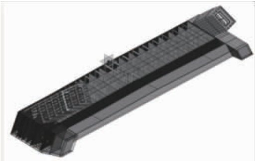
图 10 拱脚结合段建模
